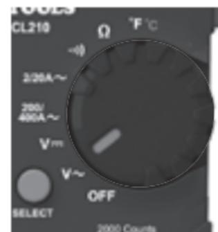
2. Aplique los cables de prueba al circuito que se probará para medir el voltaje. El multímetro seleccionará automáticamente un rango para mostrar la medición en el rango más adecuado.
