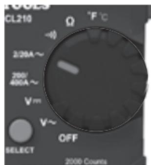
**⚠ Débranchez les fils d'essai lorsque vous faites des mesures avec la pince.**
