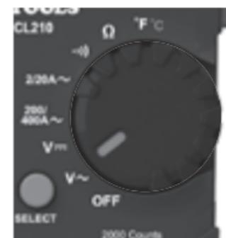
2. Appliquez les fils d'essai au circuit à tester pour mesurer la tension. Le multimètre choisira l'échelle automatiquement pour afficher la mesure dans l'échelle la plus appropriée.
