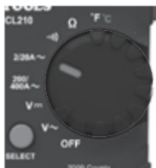
**⚠ Débranchez les fils d'essai lorsque vous faites des mesures avec la pince.**
