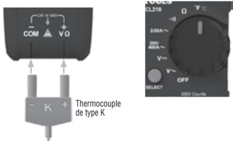
**⚠️ Retirez le thermocouple avant de sélectionner une autre fonction du multimètre.**
