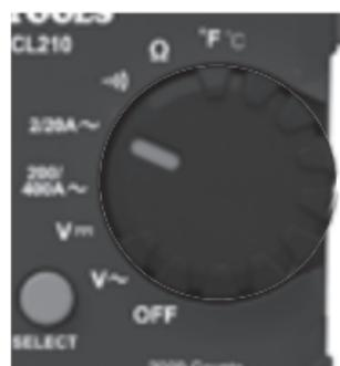
**! Desconecte los cables de prueba cuando mida con la pinza.**
