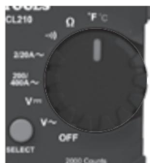
**!** *Retire el termopar antes de configurar el multímetro en otras funciones de medición.*
