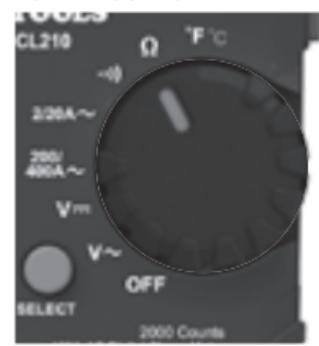
**REMARQUE :** Lorsqu'une fonction de test de résistance est sélectionnée et les fils d'essai ne sont pas en contact (ils ne sont pas connectés de part et d'autre d'une résistance), ou encore, lorsqu'une résistance défectueuse est testée, l'écran affiche « O.L. ». Cela est normal.
