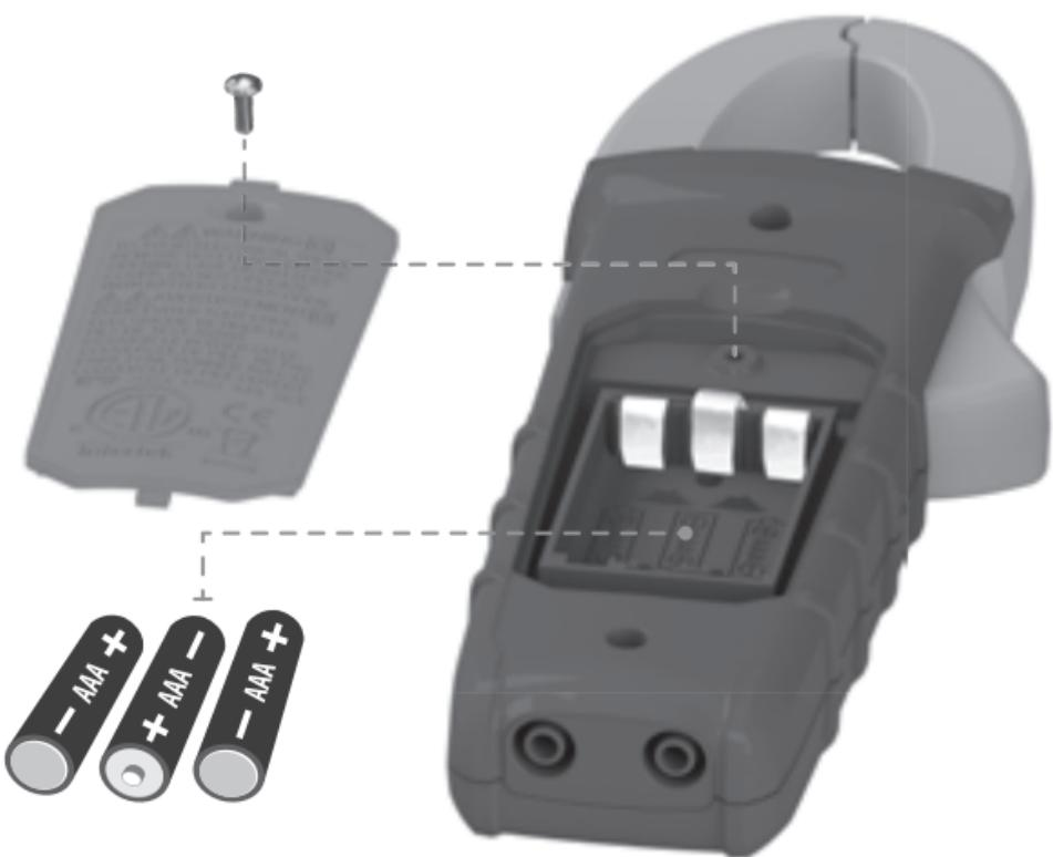
**!** *Para evitar riesgo de choque eléctrico, desconecte los cables de toda fuente de voltaje antes de retirar la puerta del compartimento de baterías.*
