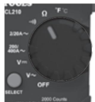
**NOTA:** Cuando el multímetro está configurado para medir resistencia y los cables de prueba están en circuito abierto (no conectados a un resistor), o cuando se está probando un resistor averiado, la pantalla muestra O.L. Esto es normal.
